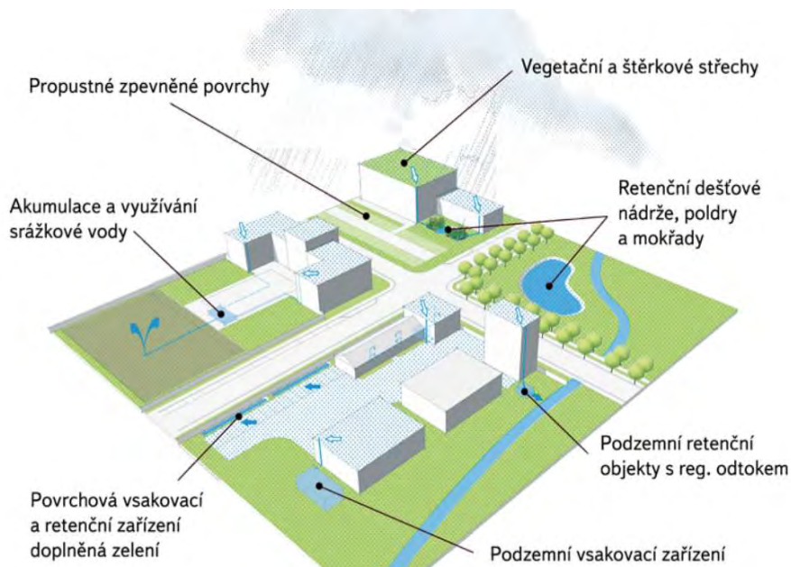
Obrázek č. 6.9.2: Princip modrozelené infrastruktury (zdroj: www.vtei.cz)
