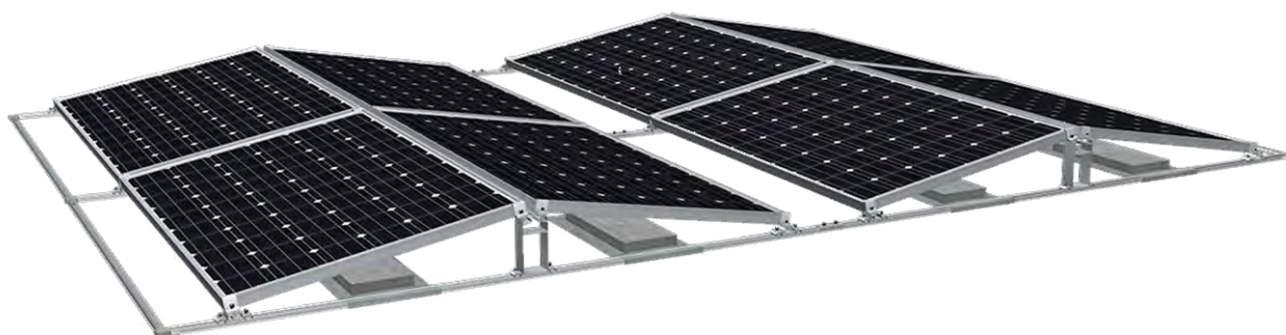
Obrázek č. 8.1.2: Panely s východo-západní orientací s přitížením samonosné konstrukce betonovými bloky
